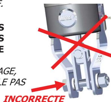
**IMPORTANT :** Afin d'obtenir une articulation optimale de l'étau avec un enrouleur, il est indispensable de disposer d'une terminaison haute avec un cardan. Par ailleurs, en ce qui concerne la terminaison basse, il est souhaitable de l'équiper également avec un cardan.
