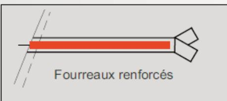
Nerf de chute avec sortie au point d'écoute et aux ris, avec blocage sur coinçeur
