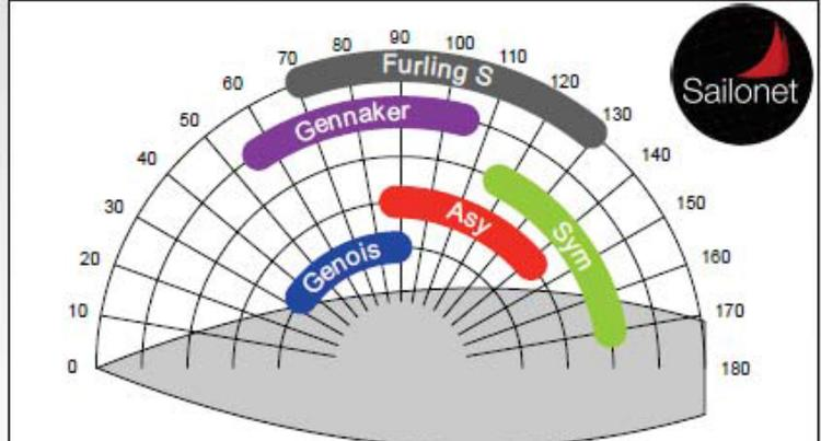
In Abhängigkeit des Segels kann der Einsatzbereich durch geringfügige Änderung von Form oder Volumen bis zu 15° Richtung downwind oder upwind angepasst werden.
